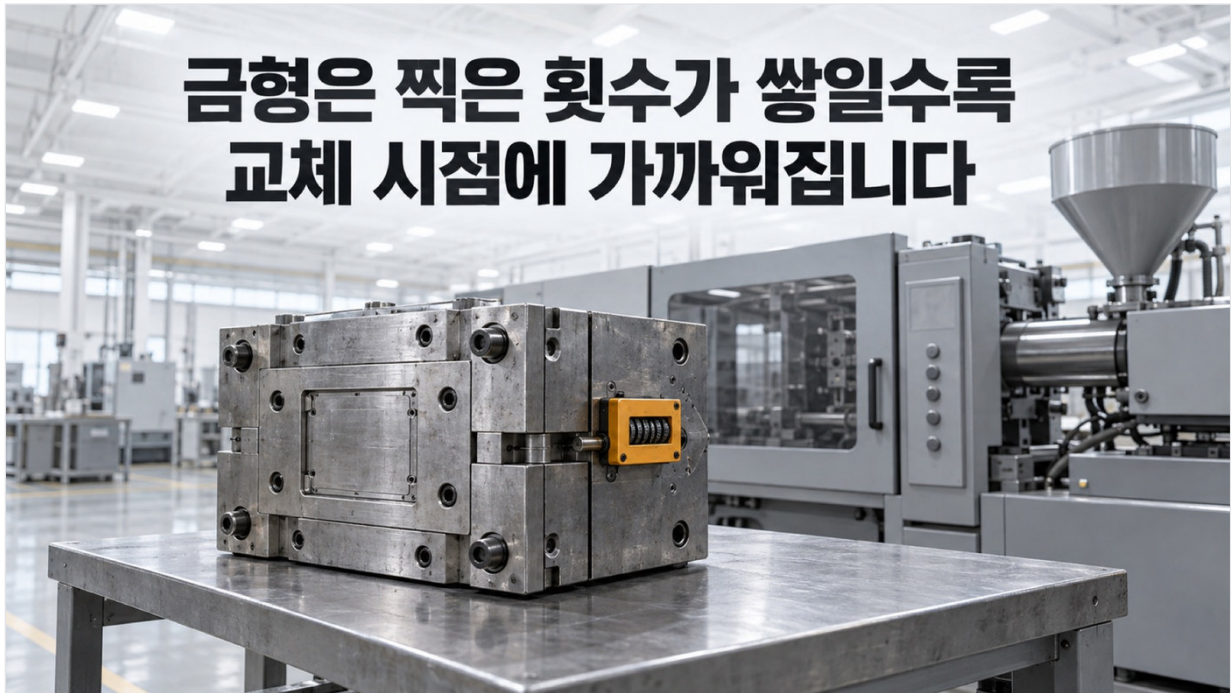
사출성형기 옆 작업대에 놓인 금형과 금형에 달린 타수 카운터 — 금형은 찍은 횟수가 쌓일수록 교체 시점에 가까워집니다
